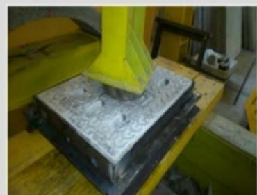
شکل ۳: نمونه منهول نانو کامپوزیت که حتی در شرایط بارگذاری نقطه ای در آزمایشگاه هم به دو تکه تقسیم نشد.
