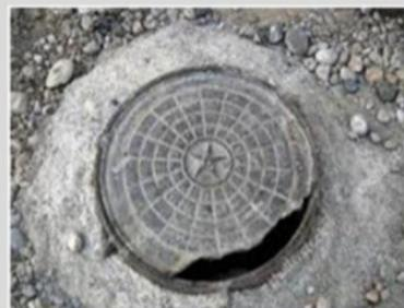
شکل ۲: نمونه محصول (چدنی) دارای رفتار ترد شکن که دو تکه شده است (دارای خطر سقوط)
