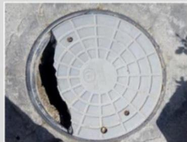
شکل ۱: نمونه محصول (پلیمری) دارای رفتار ترد شکن که دو تکه شده است (دارای خطر سقوط)
